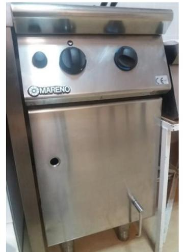
Terminata la cottura aspettare circa 1 ora in modo che si raffreddi un po' l'acqua. Svuotare la vasca solo quando l'acqua è tiepida riportando la leva in basso come in figura.
